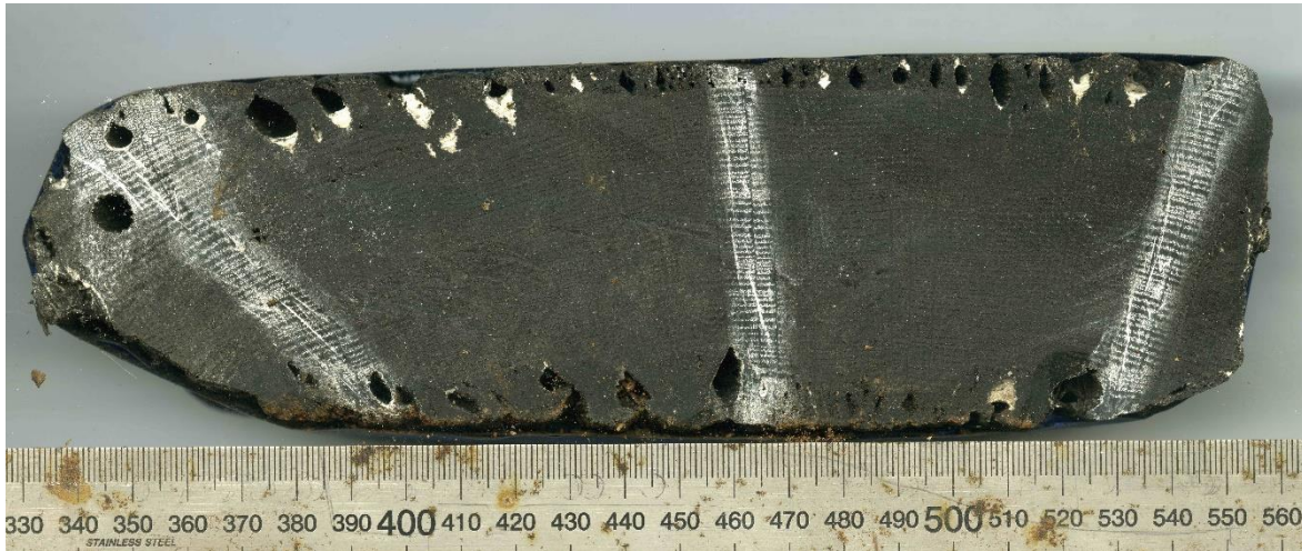
Foto: houtmonster van de huidplank van een VOC-schip. De gaten in het hout zijn veroorzaakt door paalworm. Het oppervlak van het hout is met een mesje bijgesneden en hierna is krijtpoeder in the houtcellen geklopt. Hierdoor zijn de ringen nu goed zichtbaar. De oudste ring in dit hout is gevormd in 1484 n.Chr. en de jongste ring in 1599 n.Chr.
