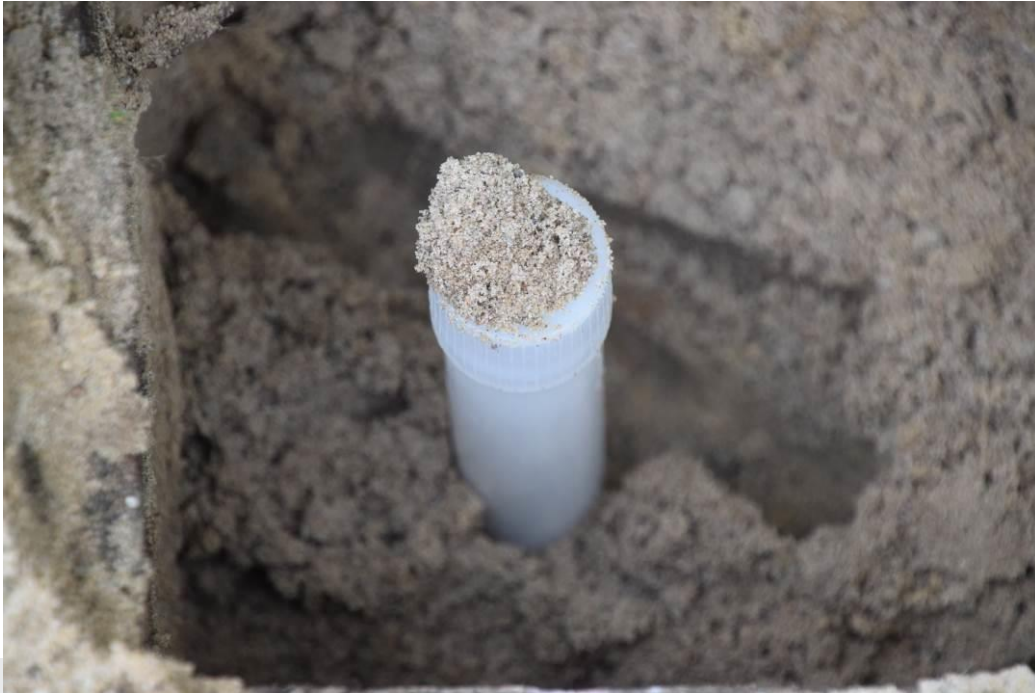
Geplaatste peilbuis in afgedicht boorgat.
